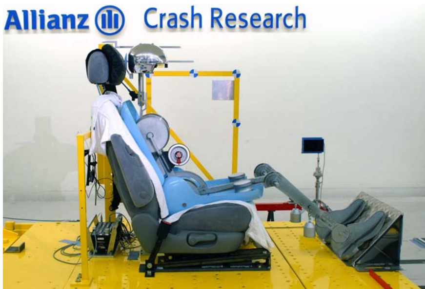
Bild 3: Einmessen des Versuchssitzes mit Kopfstützenaufsatz
