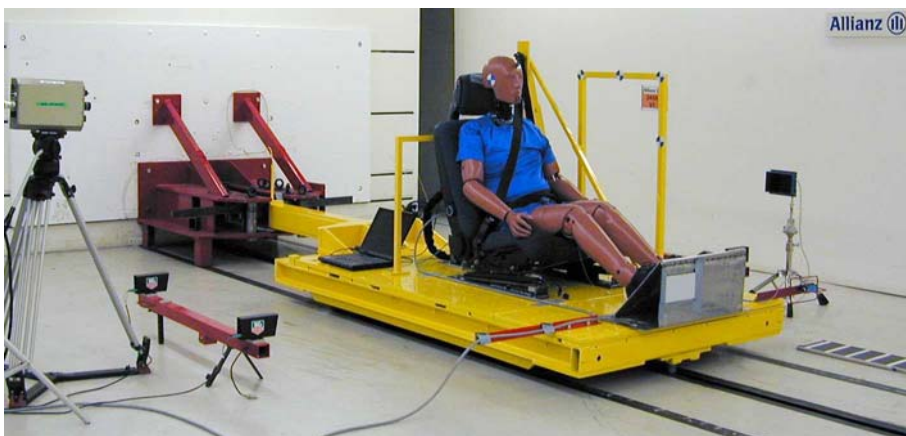
Bild 2: Versuchsaufbau für Heckaufprallversuche mit BioRid II
